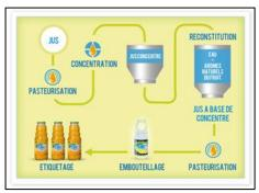
L'autre procédé, permettant de limiter le cout du transport, consiste à extraire « le concentré ».Cela consiste à réduire le jus à l'état de sirop en évaporant l'eau présente avec des bains-marie, à le pasteuriser puis le congeler sur le lieu de production. Cela réduit le volume à 10 % du volume initial. Une fois dans les pays consommateurs, le concentré est dilué avec de l'eau, du sucre peut y être ajouté. Ce procédé consomme une quantité importante d'eau.
