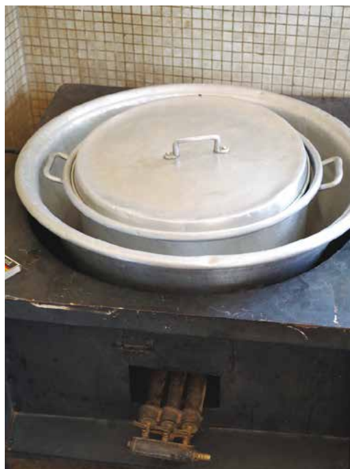
Pasteurisateur artisanal à double paroi, Burkina Faso © Gret et © C. Broutin, Gret
