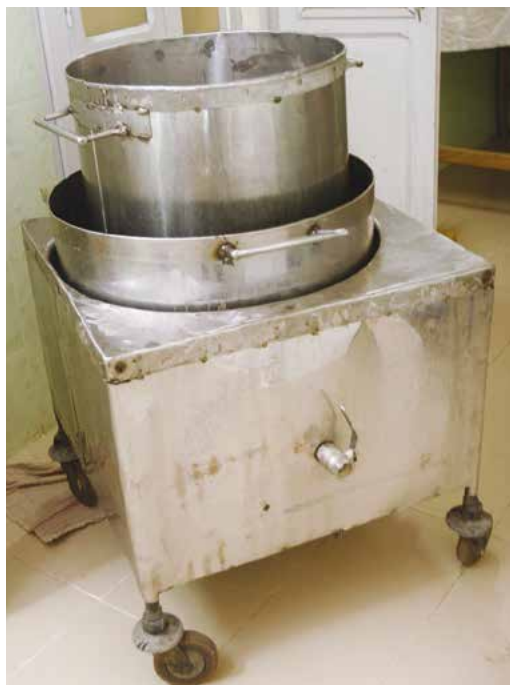
Pasteurisateur artisanal à double paroi, Burkina Faso © I. Coulibaly, Gret
